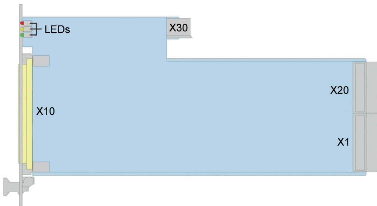
Bild 4-1 Anordnung der Steckverbinder und LEDs am Modul R&S TS-PAM
